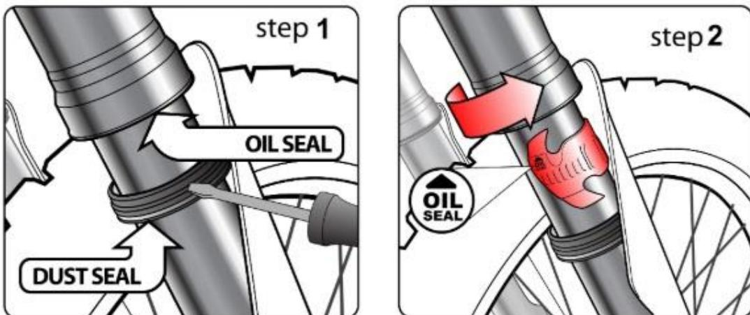
Korištenje ovog alata je jednostavno, potrebno je samo spustiti brtveni brisač prašine (slika 1) te umetnuti alat (slika 2). Zatim alat potisnuti prema gore unutar semeringa vilice te okrećući alat povlačiti ga natrag prema dolje. Ovime nakupljene nečistoće izvlačite iz semeringa. Također možete provući brtveni brisač za prašinu kroz donji zub alata kako biste i njega očistili. Prostor između brisača i semeringa dobro očistite i vratite brisač prašine na svoje mjesto.
